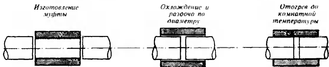
Рис. 5. Схема получения соединения с использованием муфты из сплава с памятью.
